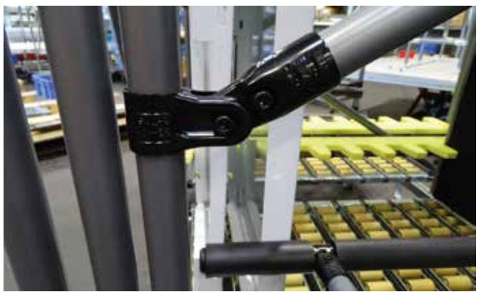
**G-7AS** Поворотный соединитель, односторонний
